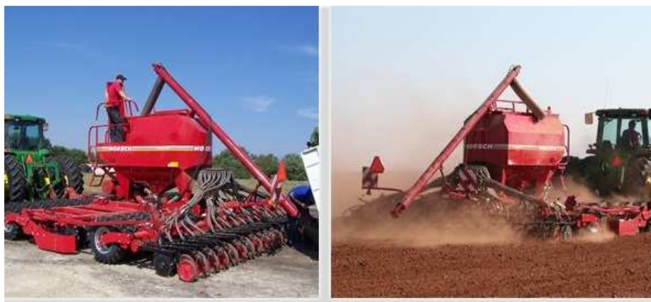
Obr. 19: Plnenie zásobníka pomocou plniacej závitovky.
