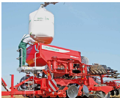
Obr. 18: Plnenie zásobníka pomocou big bagu.
