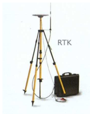
Obr. 27: Systém smerové navádzania Star Fire: vľavo vysielací modul, vpravo prenosná stanica RTK.
