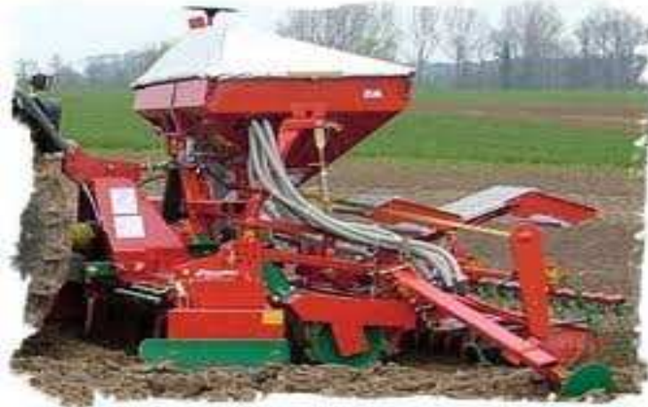
Obr. 14: Kombinovaný stroj pre predsejbovú prípravu a sejbu (poorbe).
