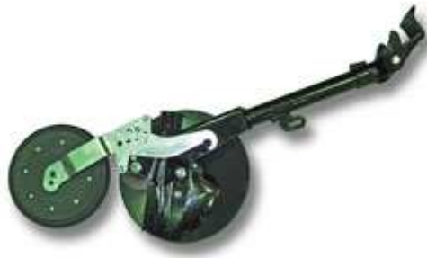
Obr. 24: Jednokotúčová výsevná pätká s utužovacím kolieskom ktoré slúži aj ako hĺbkové vedenie.
