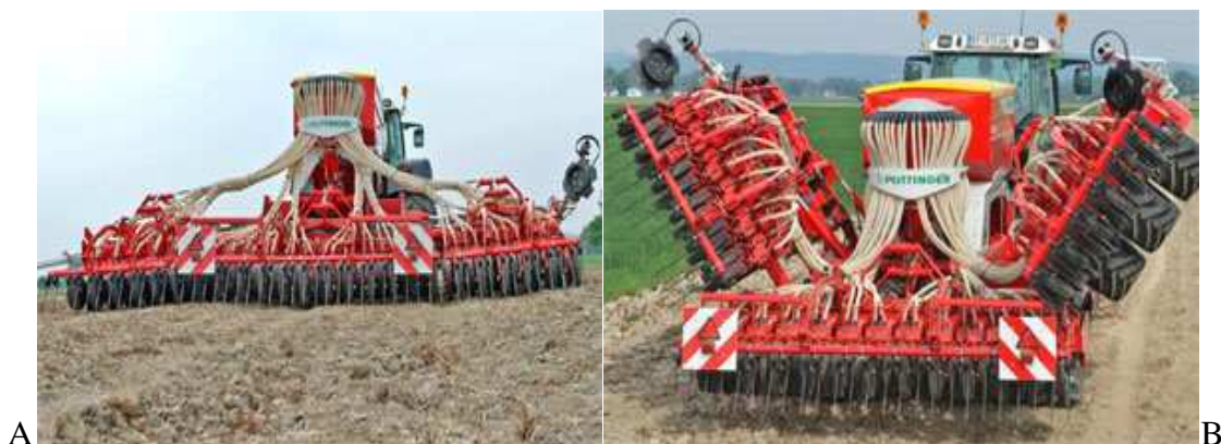
Obr. 20: Sejací stroj Pöttinger Terasem s deleným nosníkom výsevných pätiiek: A) priečne kopírovanie nerovností, B) skladanie do prepravne polohy.
