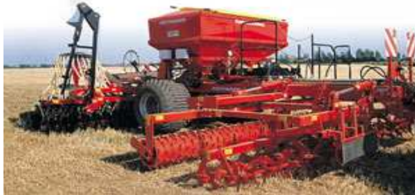
Obr. 17: Sejacia súprava Pöttinger Terasem 6000 s hviezdicovým pôdospracujúcim ústrojenstvom a zubovým valcom.
