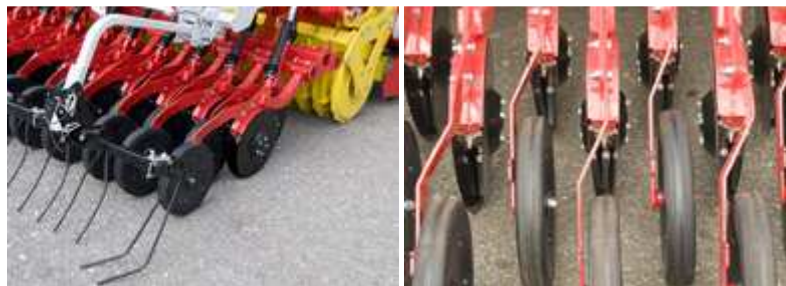
Obr. 25: Dvojkotúčové výsevne pätky Dual-Disc s utlačiacim kolieskom slúžiacim aj pre hĺbkové vedenie od firmy Pöttinger.
