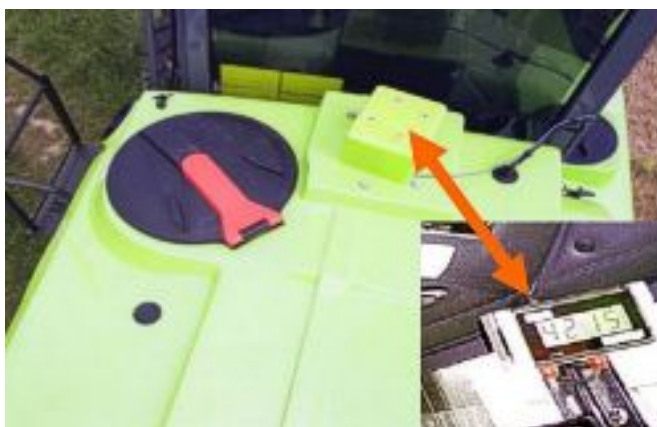
Obr. 13 Objem kvapaliny v nádrži sledované elektrickým zariadením NIVOTRONIC. (Zdroj: http://www.agrabat.com/samochodne.html ).
