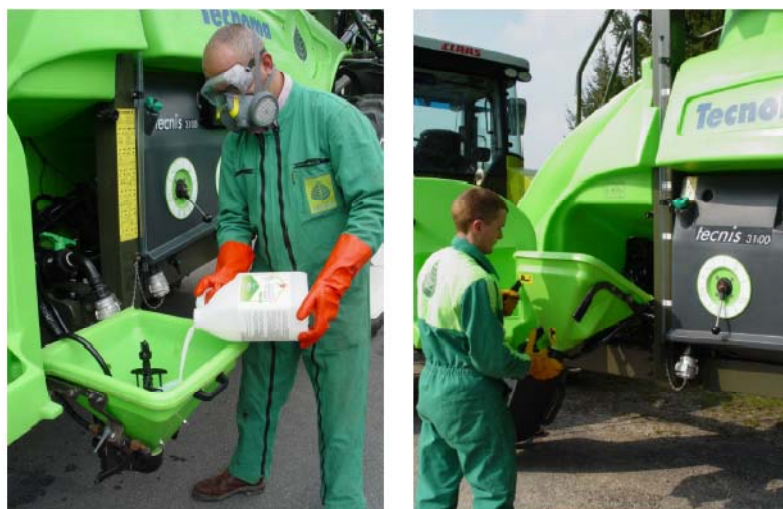
Obr. 17 Miešanie, premývanie a uzatváranie chemickej miešacej jednotky.
