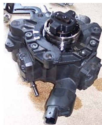
Obr. 16 Common Rail vysokotlakové čerpadlo
