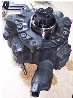
Obr. 21 Common-Rail-vysokotlakové čerpadlo Obr. 22 Vstrekovače Common-Rail ( http://www.ford-focus.cz/forum/viewtopic.php?t=5873&p= )
