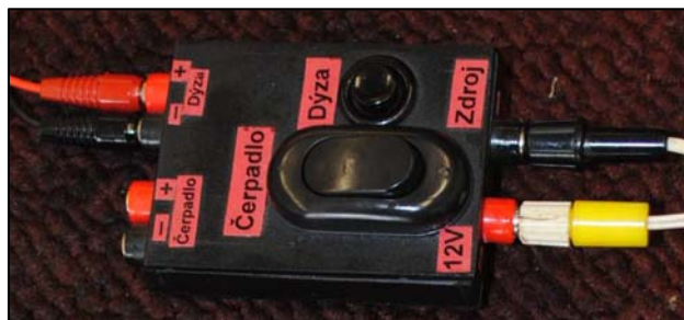
Obr. 28 Riadiaci modul kontroly vstrekovačov
