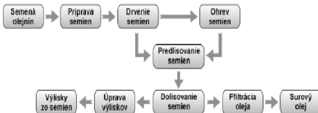
Obr. 2 Schéma výroby surového oleja systémom predlisovanie – dolisovanie
