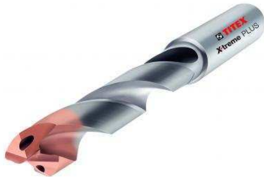
Obr. 11 Výkonný monolitný vrták Titex X-treme PLUS s dvojitým povlakom DPL pre vrtanie do hĺbky až 5xD (Horváth, 2009)
