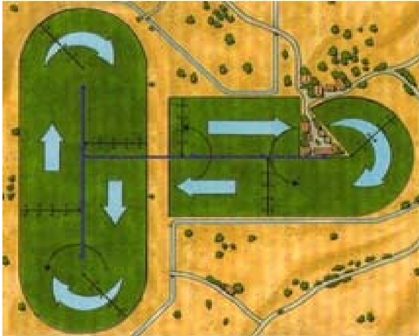
Obr. 18 Pohyb zavlažovača Centerliner CLE (CLE, 2011)
