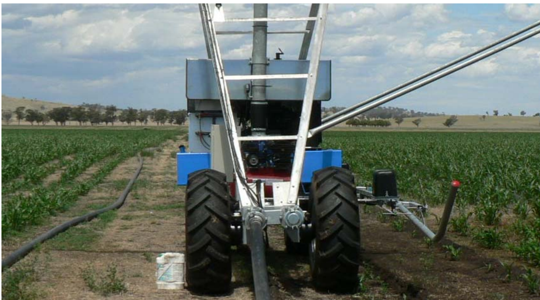
Obr. 29 Systém brázdového navádzania zavlažovača
