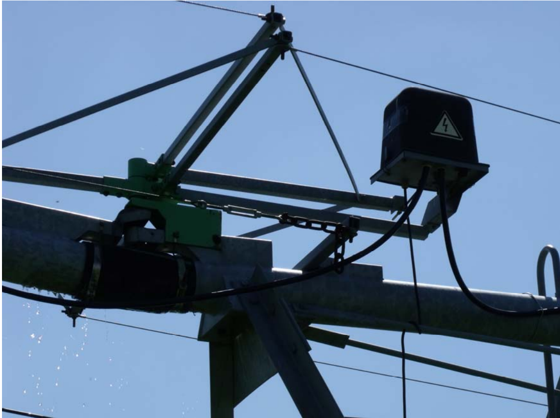
Obr. 31 Systém elektrického navádzania zavlažovača
