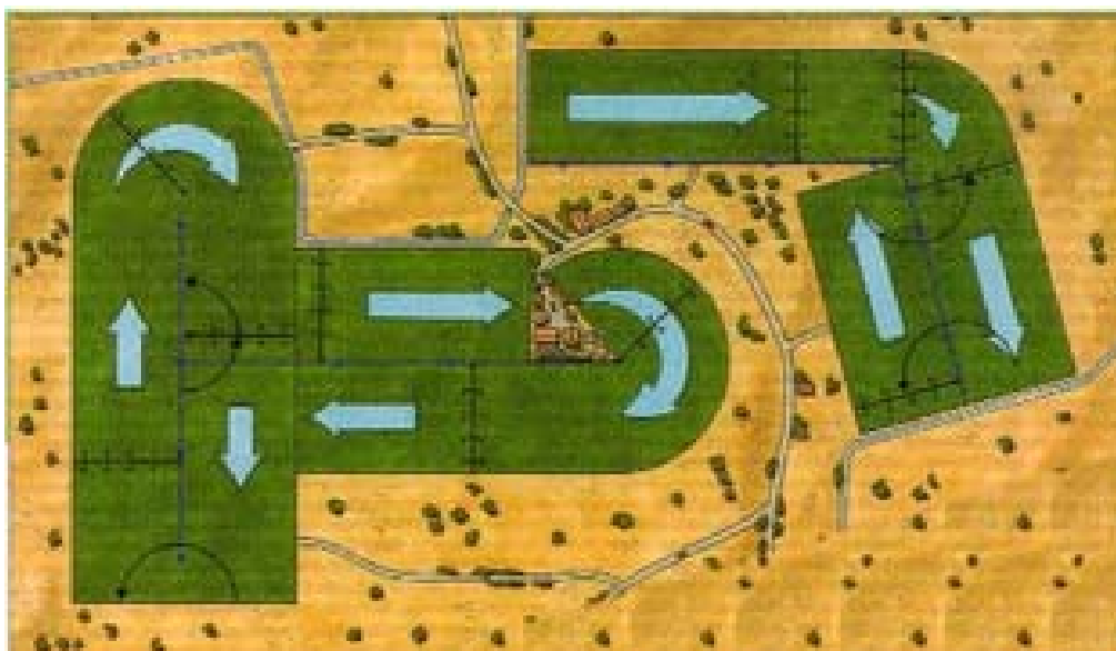
Obr. 19 Pohyb zavlažovača Centerliner CLX (CLX, 2011)
