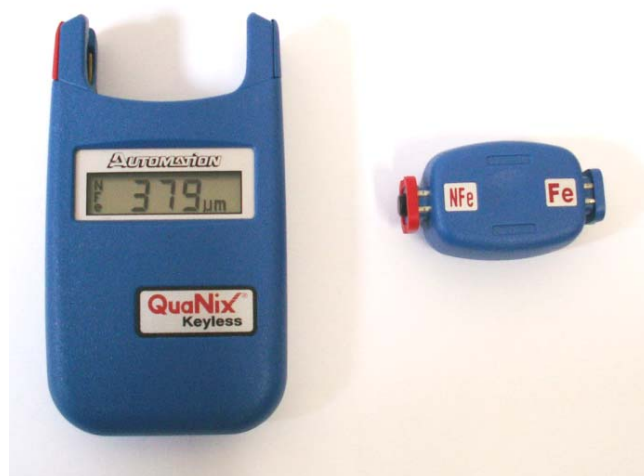
Obr. 3.4 Merací prístroj QuaNix Keyless so sondou (Jankura, 2011)
