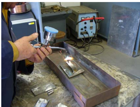
Obr. 3.10 Proces navárania vzoriek
