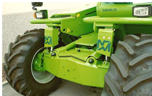
Obr.22 Hydropneumatické závesy manipulátora Merlo
