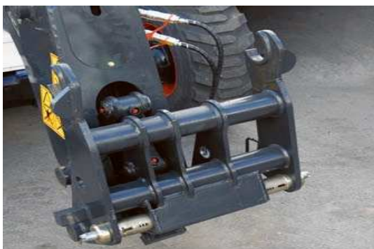
Obr. 30 Pohľad na rýchlopínacie zariadenie Quick-Tac ( http://www.bobcat.cz/ )
