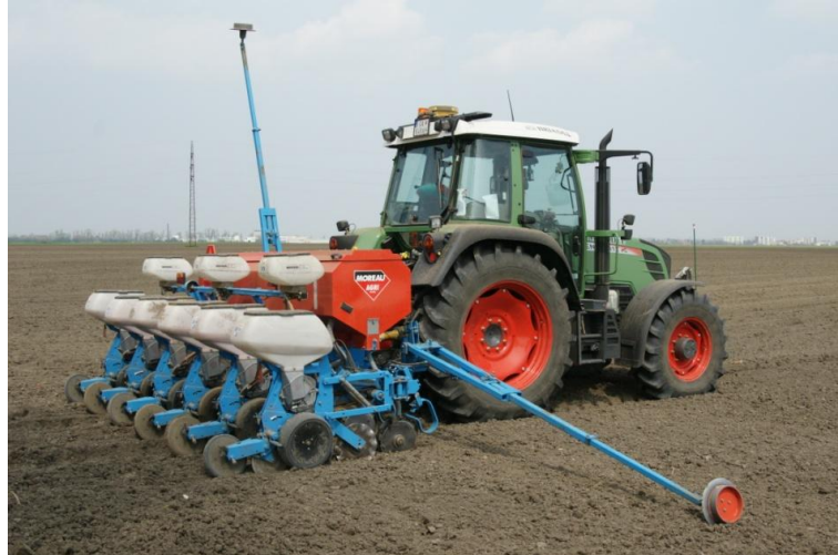
Obr. 16: Sejba matky presnou jednozrnkovou sejačkou MOREAU AGRI Monosem
