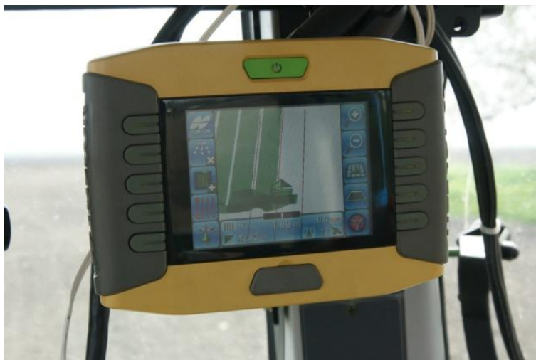
Obr. 7: Komunikačný terminál obsluhy s navigáciou
