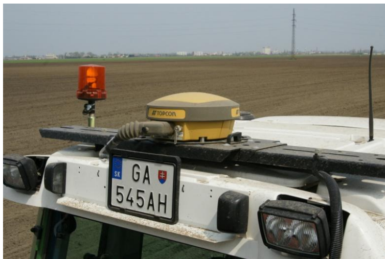
Obr. 8: Satelitný prijímač GPS AGI-3 namontovaný na streche traktora
