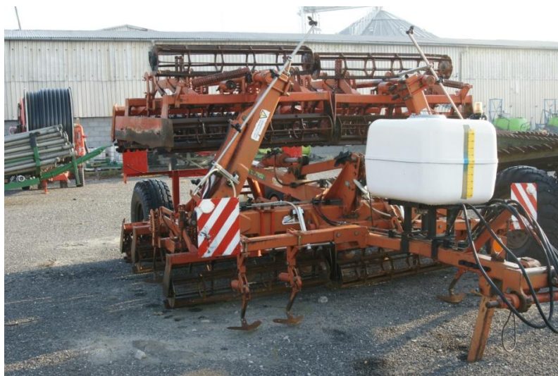
Obr. 15: Kompaktor s možnosťou prihnojovania Ostrom-Opava
