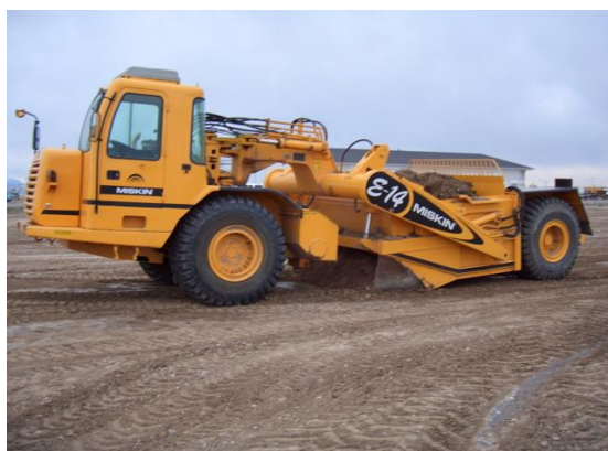
Obr. 35 Motorový scraper E-14M, motor cummins 5,9L
