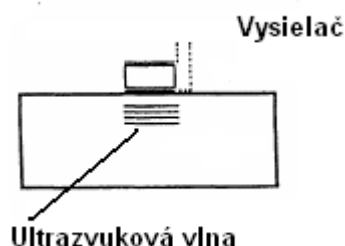
Obr. 11 Piezokryštál ako vysielateľ ultrazvukovej vlny
