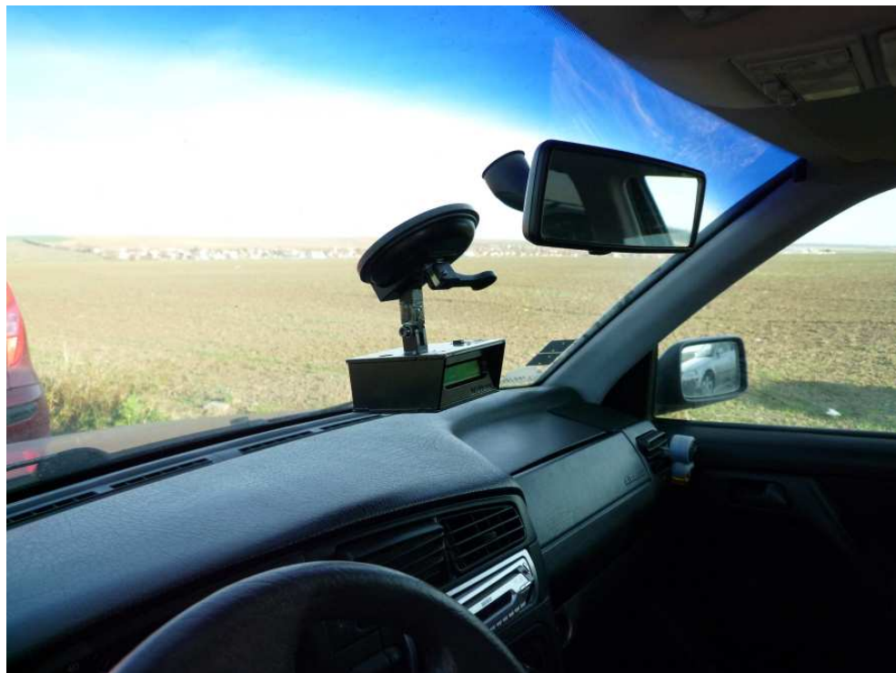
Obr. 18 XL-Meter namontovaný na čelnom skle vozidla VW Golf
