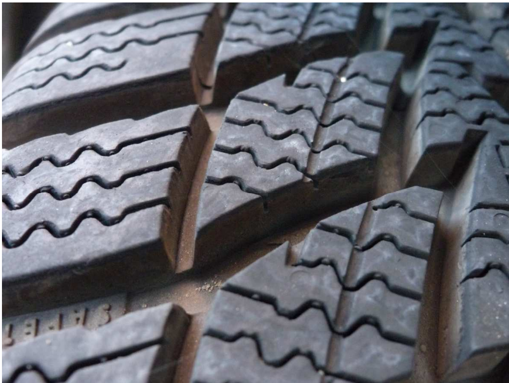
Obr.37 Dezén na zimnej pneumatike Matador Nordica Basic
