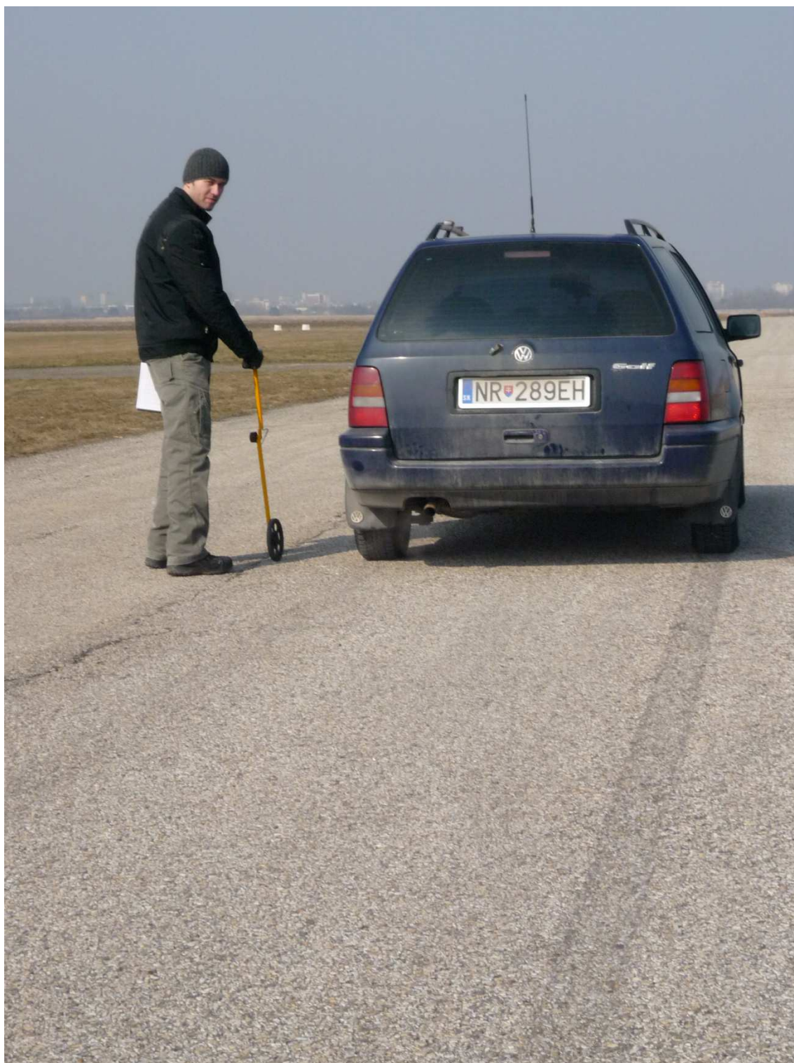
Obr.34 Meranie brzdej stopy pri zimnom meraní
