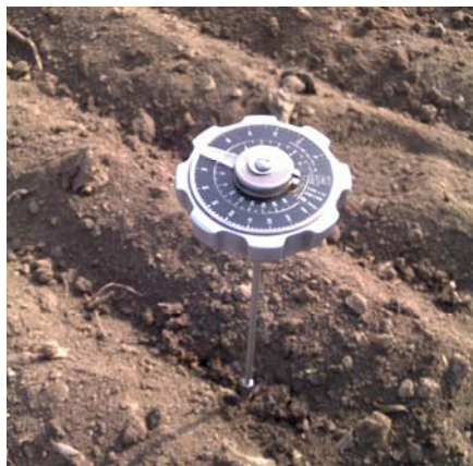
Obr. 3 Ručný vrtuľkový prístroj typu PILCON – EDECO na zisťovanie šmykového odporu pôdy
