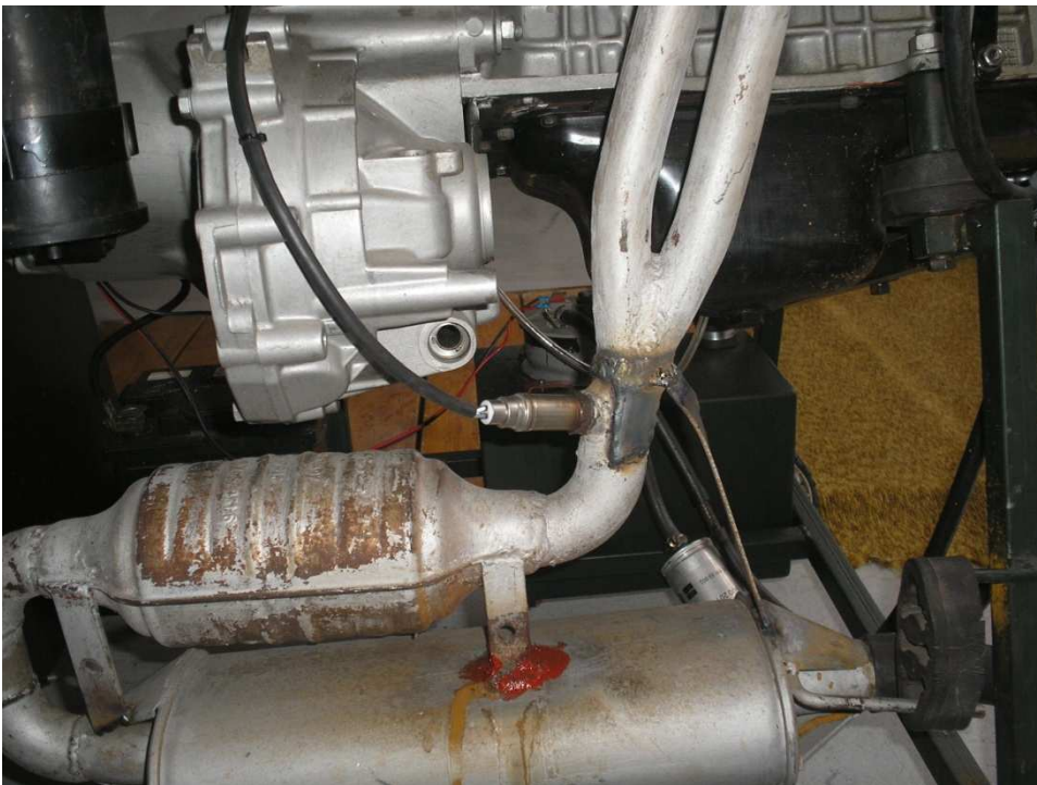
Pohľad na \lambda sondu modelu benzínového motora Škoda Felícia 1,3 MPi
