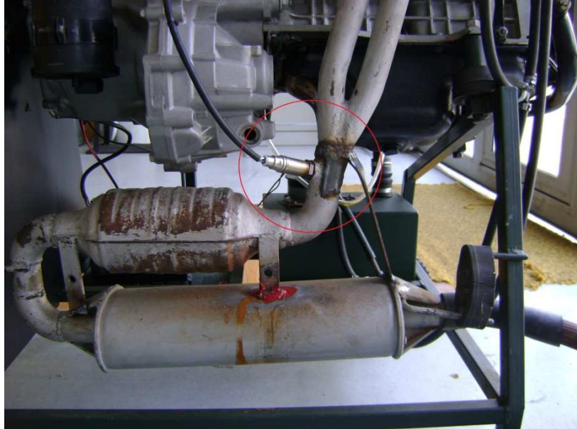
Obr. 3.5 Lambda sonda na modeli benzínového motora Škoda Felícia 1,3 MPi
