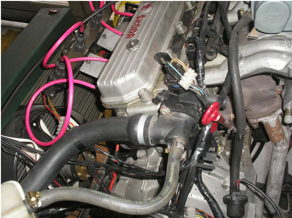
Pohľad na termostat na modeli benzínového motora Škoda Felícia 1,3 MPi
