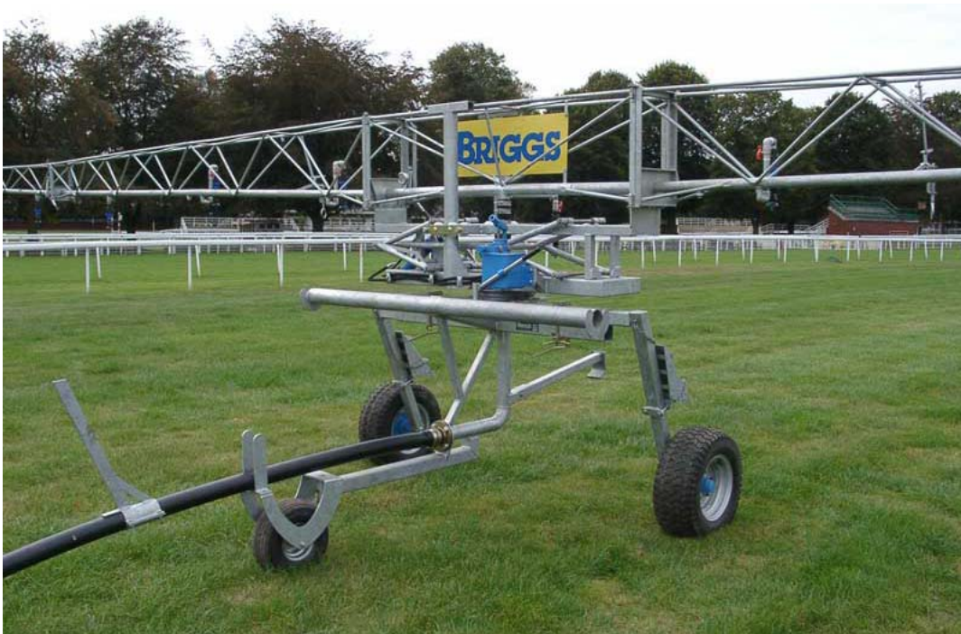
Obr. 4 Konzola na pásový zavlažovač (Briggs Irrigation, 2011)
