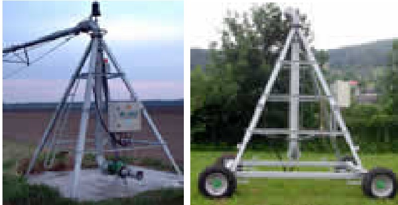
Obr. 28 Centrálna veža: a) pevná, b) pohyblivá (Bauer1, 2011)
