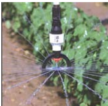
Obr. 26 Dýzy Senninger: a) LDN (Low Drift Nozzle), b) Super Spray (Manuál Valley 2, 2011)
