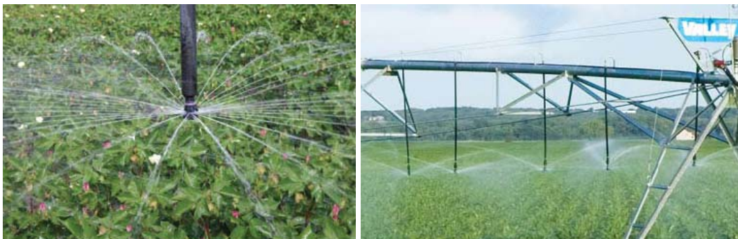
Obr. 24 Nízkotlakové dýzy (Manuál Valley 2, 2011)
