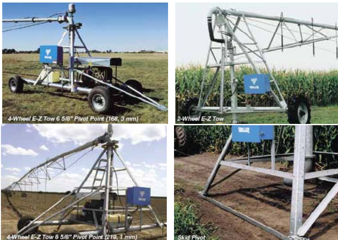
Obr. 10 Mobilné modifikácie pivota u zavlažovačov Valley (Manuál Valley 1, 2011)
