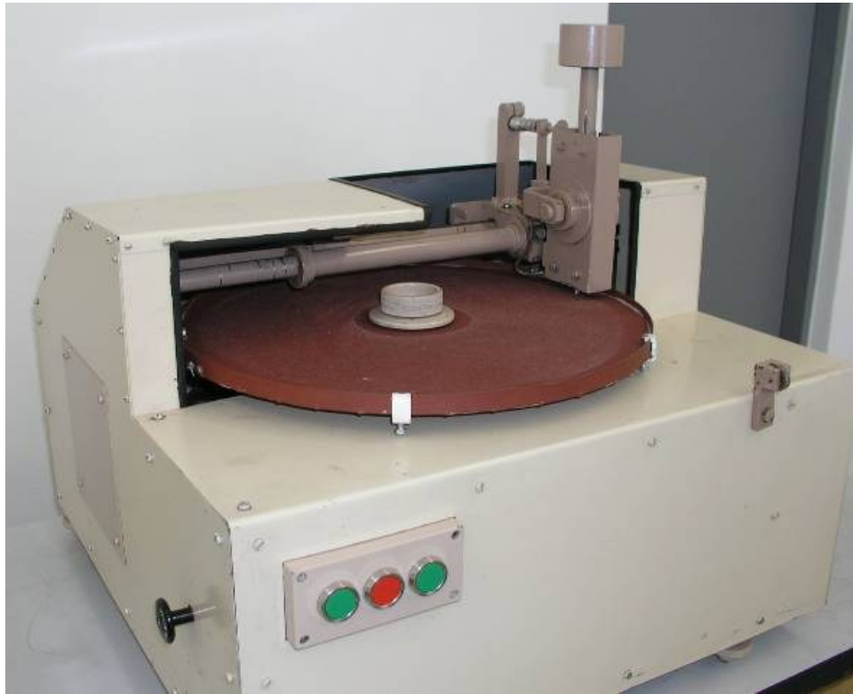
Obr.15 Skúšobný prístroj na stanovenie pomernej odolnosti proti opotrebeniu
