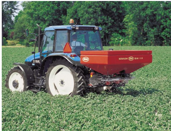
Obr.1 Odstredivý rozhadzovač tuhých priemyselných hnojív Vicon Rotaflow RS-M.
