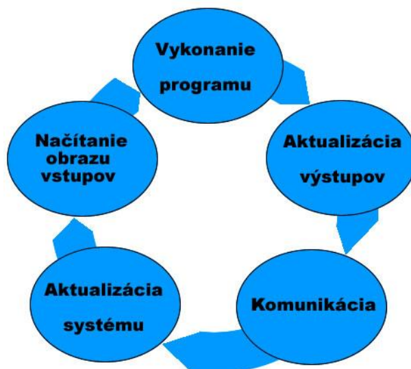
Obr. 3 Zjednodušený operačný cyklus procesora
