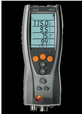
Obr. 10 Meracie zariadenie TESTO 327-1 ( zdroj internet)
