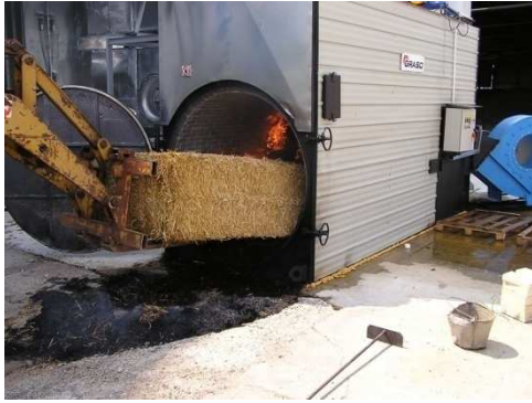
Obr. 12 ,13 Ohrievač vzduchu NPA 1200 (zdroj internet)
