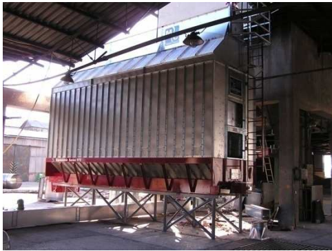
Obr. 14,15 Sušiareň MC 975 (zdroj internet)
