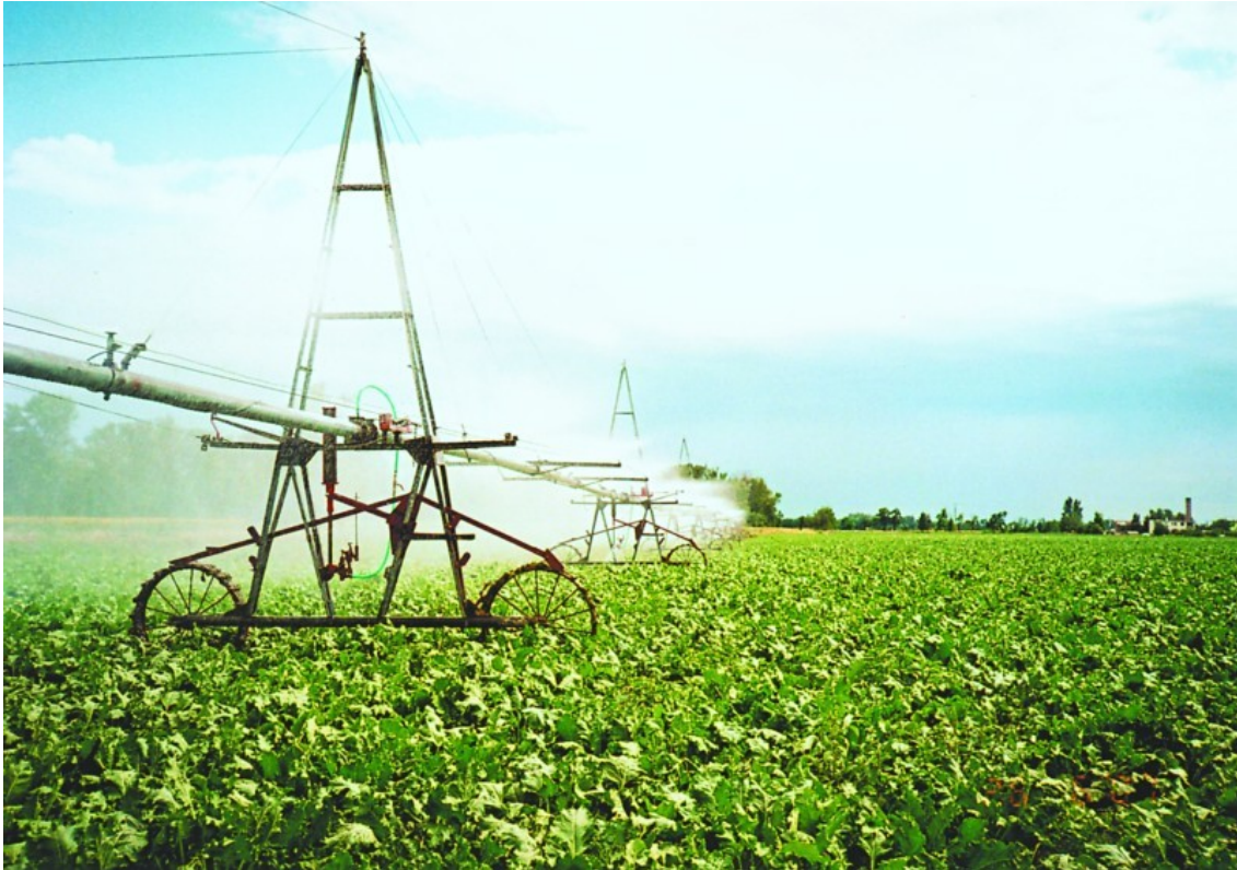
Obr. 9 Širokozáberový zavlažovač (Agref, 2011)
