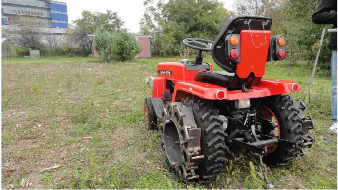
Obr. 3. Namontované hrotové koleso na traktore
