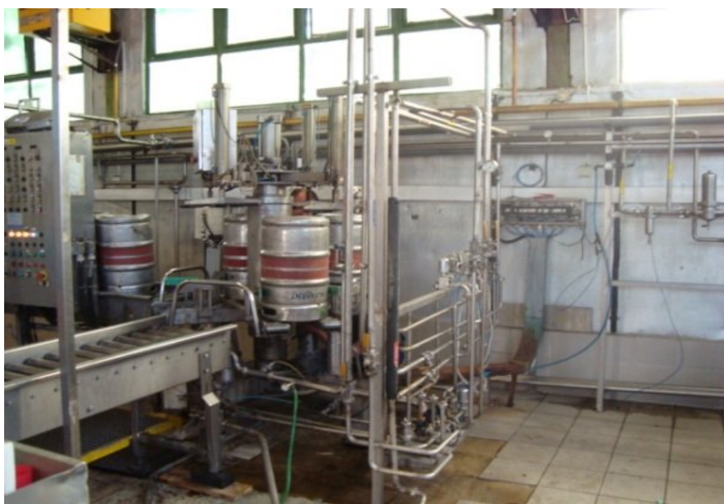
Obrázok 6 Zariadenie Rotokeg – plnenie keg sudov
